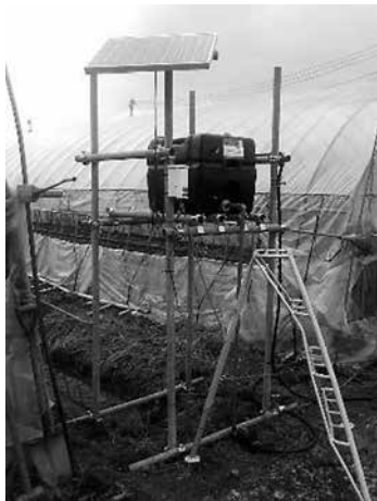
写真4 日射制御型自動灌水装置のソーラーパネルと拍動タンク
