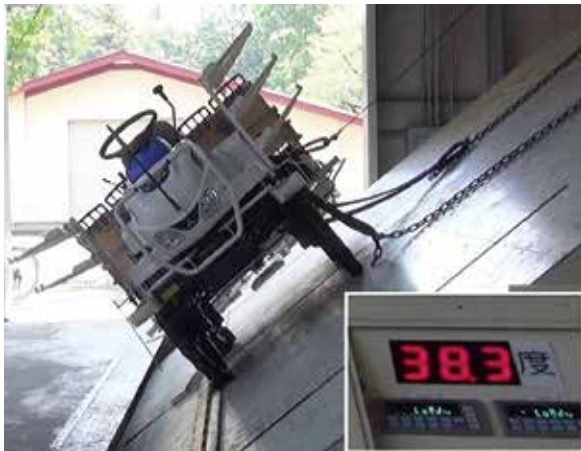
写真4 静的横転倒角の計測の様子（田植機装着時）
