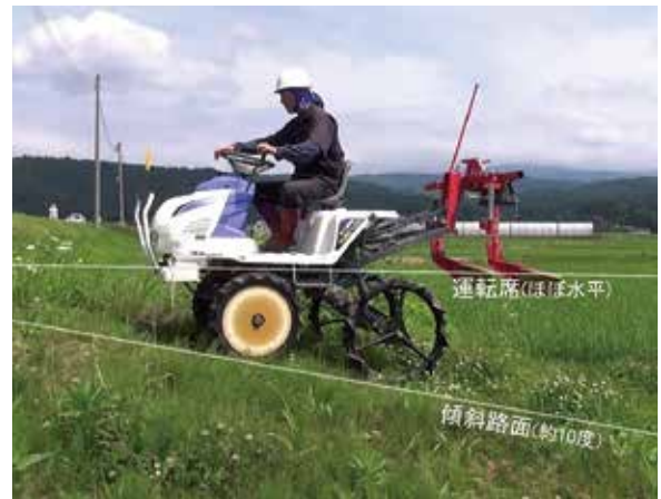
写真3 後輪昇降機構を利用した傾斜地走行の様子（溝切機装着時）
